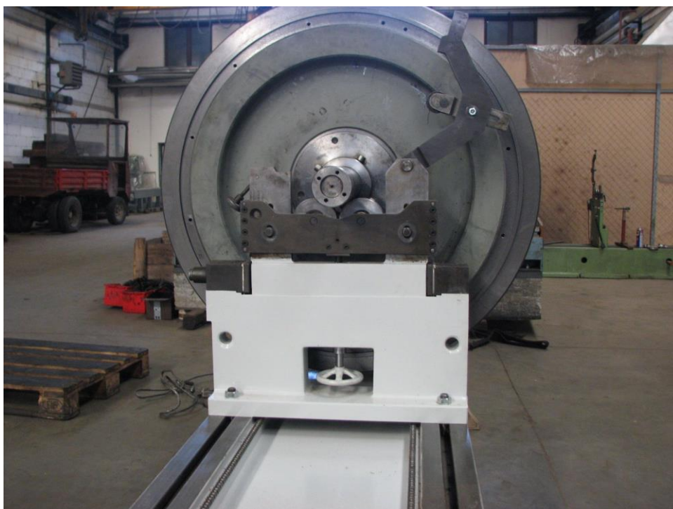
19. Ispitivanje proizvedenog stroja za dinamičko uravnoteženje masa.
