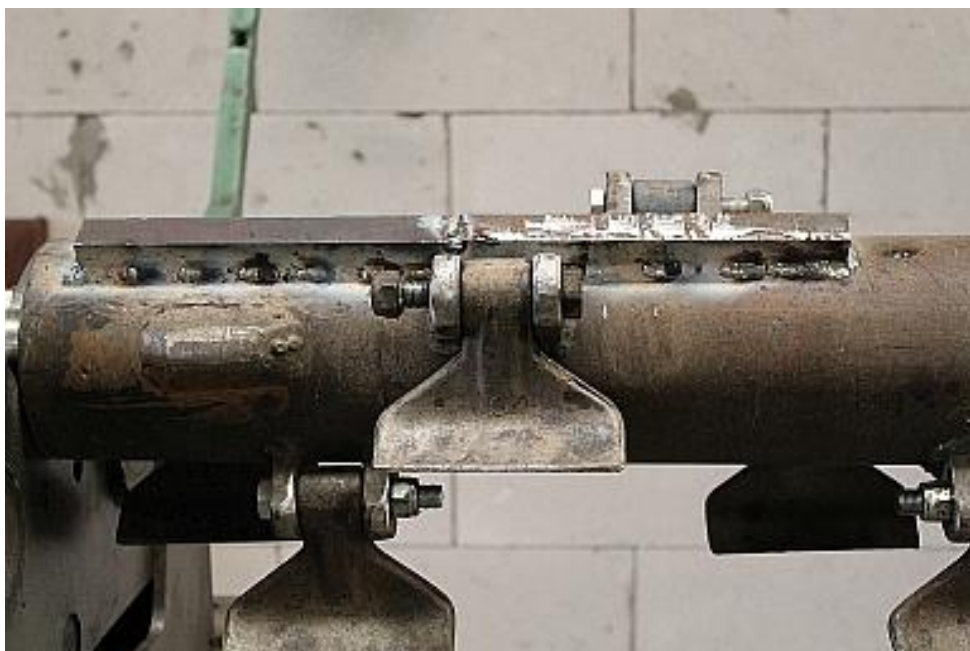
12. Rotor malčera - ravnanje i dinamičko uravnoteženje u našem pogonu.
