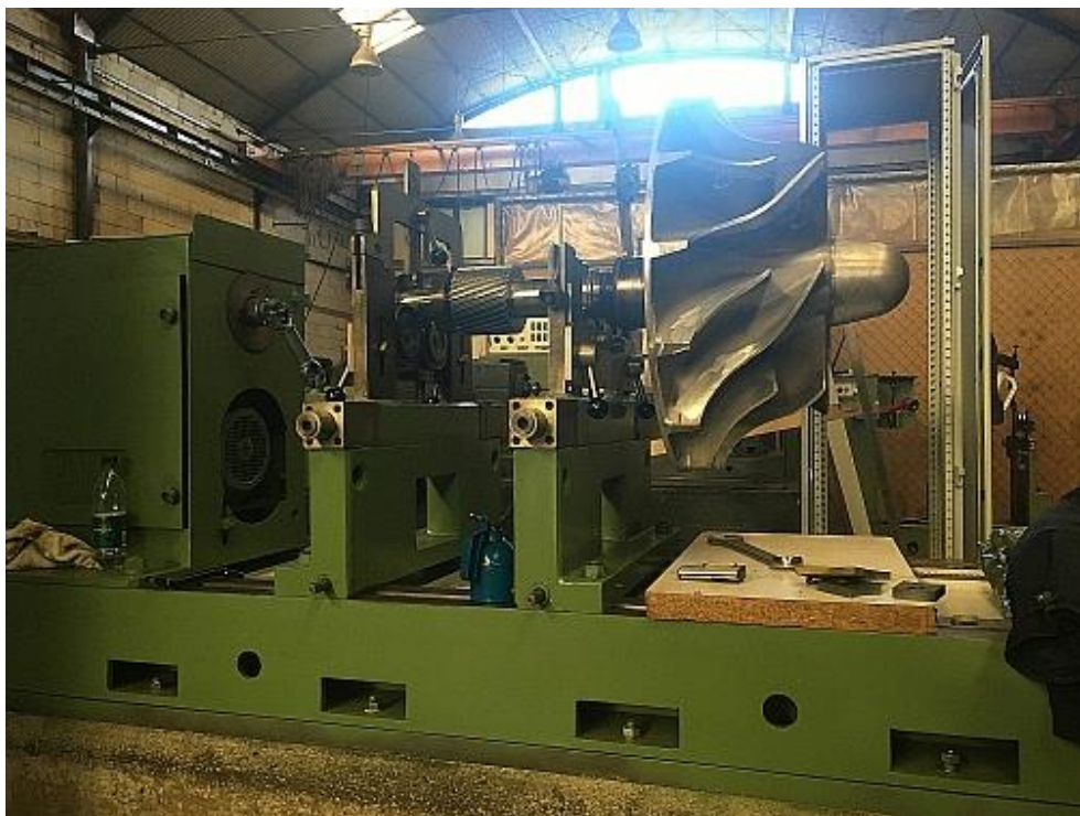
11. Rotor turbopuhala - dinamičko uravnoteženje na stroju za dinamičko uravnoteženje masa u našem pogonu.
