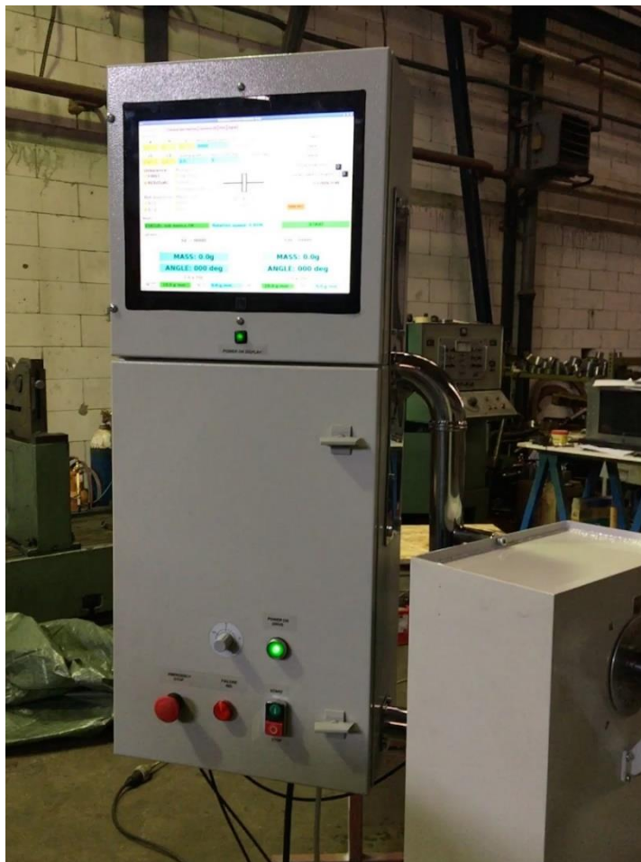
22. Upravljački ormar stroja za dinamičko uravnoteženje masa sa zakretnim mehanizmom upravljačkog ormara proizveden prema narudžbi kupca.
