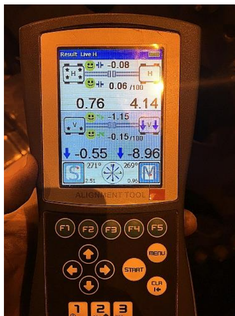
8. Laserski uređaj za mjerenje centričnosti odnosno lasersko centriranje osi rotacije.
