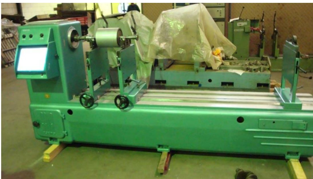
14. Stroj za dinamičko uravnoteženje masa marke "Elettrorava" nakon retrofita.
