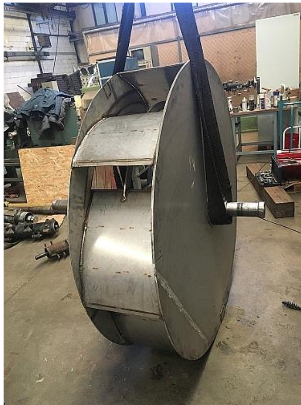
10. Rotor ventilatora - dinamičko uravnoteženje u našem pogonu.
