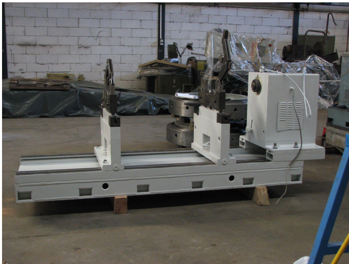
18. Stroj za dinamičko uravnoteženje masa proizveden po narudžbi kupca.
