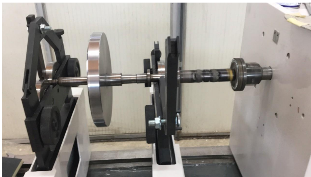
20. Stroj za dinamičko uravnoteženje diska proizveden prema narudžbi kupca.
