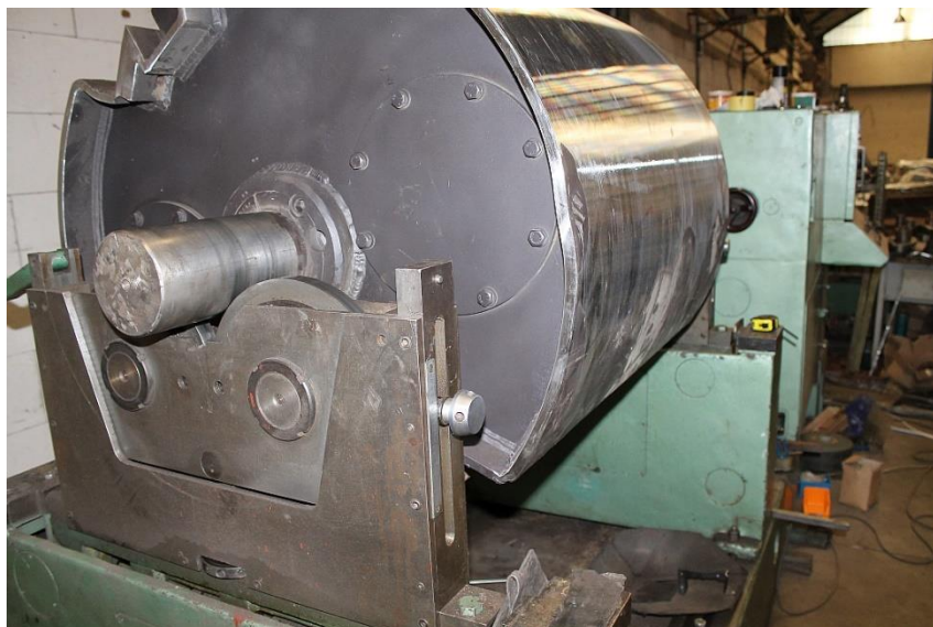
1. Dinamičko uravnoteženje rotora mlina drvene mase
