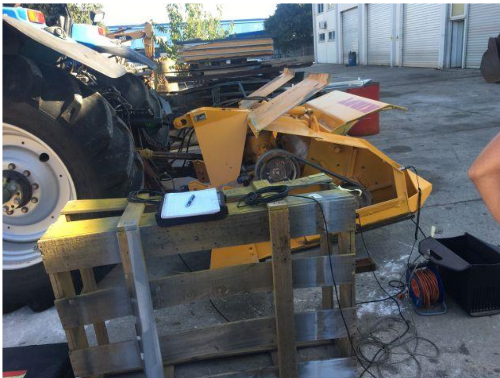
3. Dinamičko uravnoteženje rotora malčera na licu mjesta.
