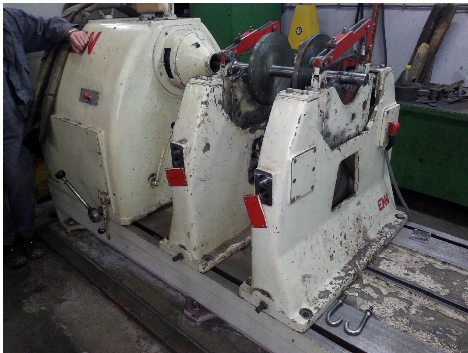
15. Popravak senzora za mjerenje sila na starom stroju za dinamičko uravnoteženje masa.
